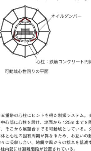
法隆寺五重塔の心柱にヒントを得た制振システム。タワーの中心部に心柱を設け、地面から125mまでを固定域に、そこから展望台までを可動域としている。タワー本体と心柱の固有周期が異なるため、お互いの動きを徐々に吸収し合い、地震や風からの揺れを低減する。心柱内部には避難階段が設置されている。
